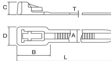
耐薬品性に優れたポリプロピレン製のリピータイルです。保守、点検と、再結束が必要な配線の結束にご使用頂けます。
