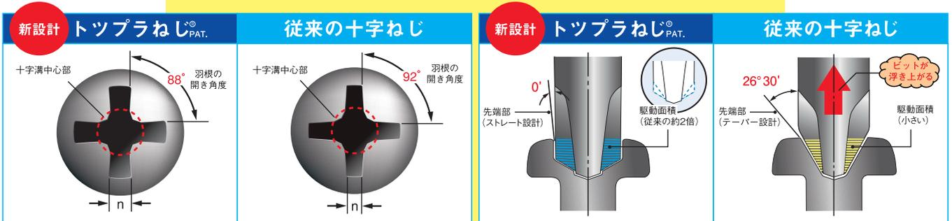
**1:** 従来の十字ねじとの互換性を保ちながら、トルクの伝達効率を向上させ、より小さな力で安定したねじ締めを実現します。特に自動化に適しています。
