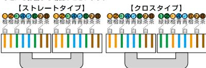
5. コードの芯線がプラグ端子にしっかり圧着されているか確かめください。(完成図)
