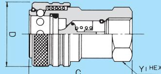
材 質：スチール (表面処理：電気亜鉛メッキ・クロメート処理) 適用温度範囲：-30℃～+100℃
