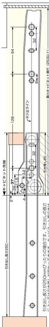
引き出し長さ250の場合です。引き出しの長さによって引き残しが変わってきます。キャビネット実行きは、引き出し長さ+3mm以上 (ただし最小でも253mm以上) 必要です。
