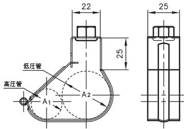
冷媒配管用の吊金具。
